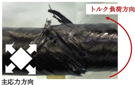
図2 FRPシャフトの破壊様相
