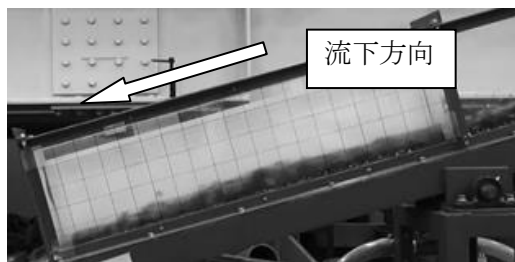
写真-2 砂礫の流下状況
