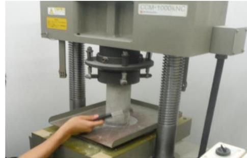
写真1 接触時間の測定状況
