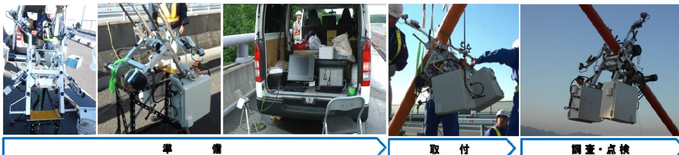
図3 自走式点検装置を用いた点検手順
