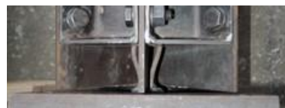
図4b 補強タイプBの破壊性状(λ=120)
