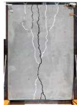
写真-2 ひび割れの発生状況
