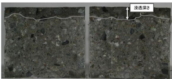
図.2 透水試験後(割裂後)の供試体
