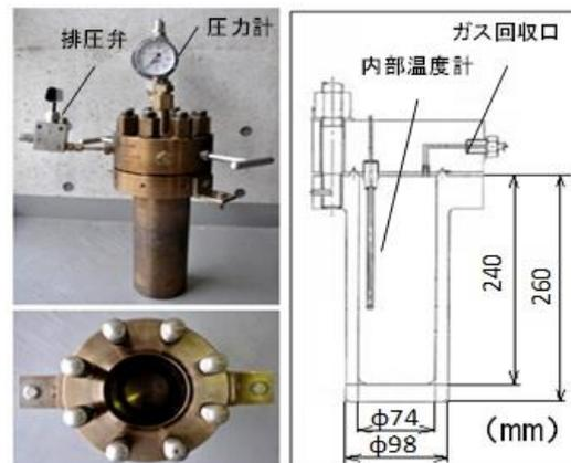
図2 試験装置の構造と仕様
