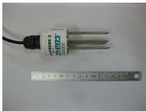
図1 HP II (金属部分がセンサロッド)
