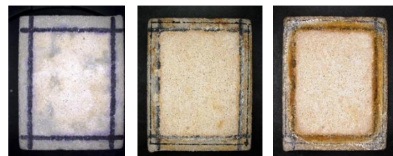
図3 中性化あり， \text{CO}_2 + \text{H}_2\text{S} 供試体の顕微鏡で撮影した供試体 (左より0週目，40週目，55週目)
