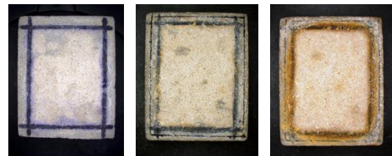
図2 中性化あり， \text{CO}_2 供試体の顕微鏡で撮影した供試体 (左より0週目，38週目，55週目)
