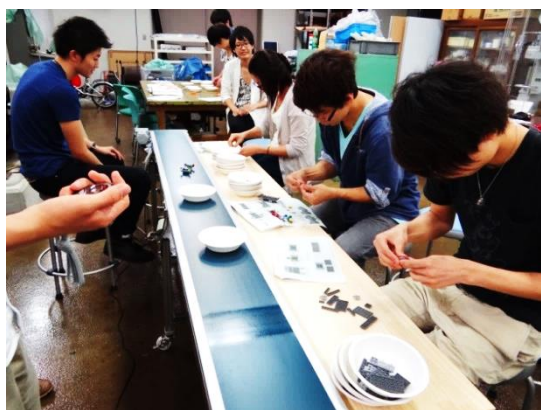
写真2. ミニカーの組立て（ライン生産）
