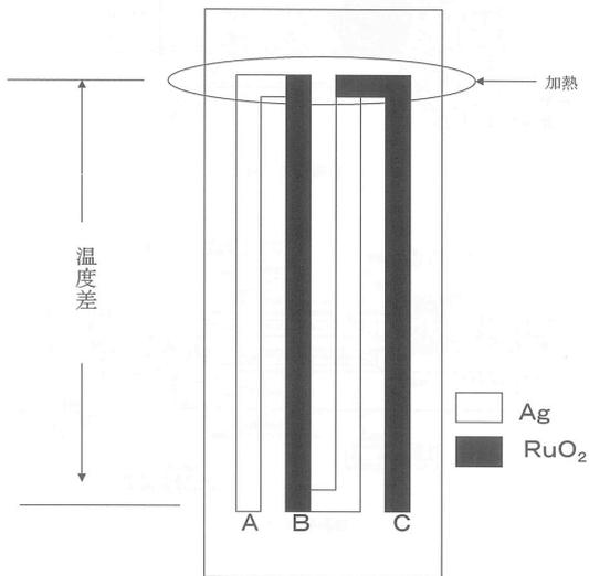
Fig.5 特性測定用試料の形状
