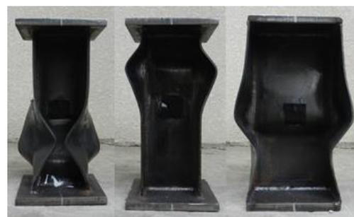
図-4 鉄骨の最終破壊形状
