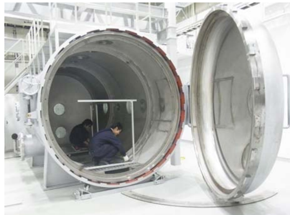
図7 40号館1階の真空チャンバー(LINCS)の整備の様子
