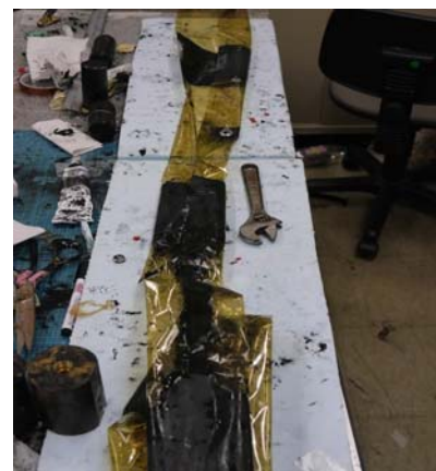
図5 インフレータブルトーラスの気室層の概観図
