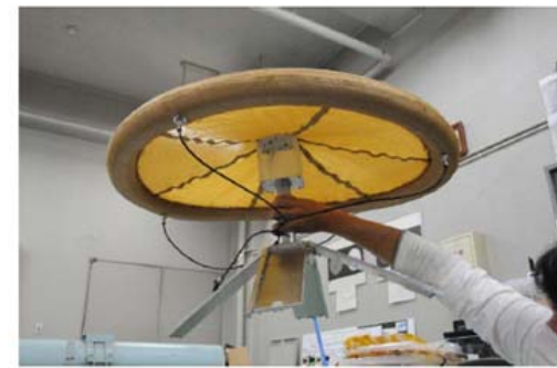
図6 展開試験用のモックアップの収納、展開時の様子
