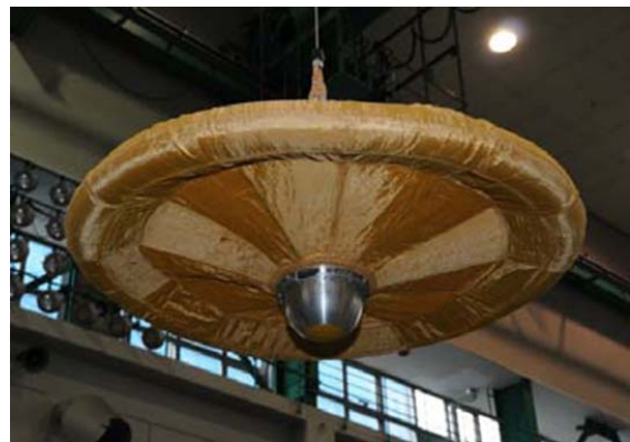
図2 インフレーターブルチューブを有するフレア型の再突入機模型
