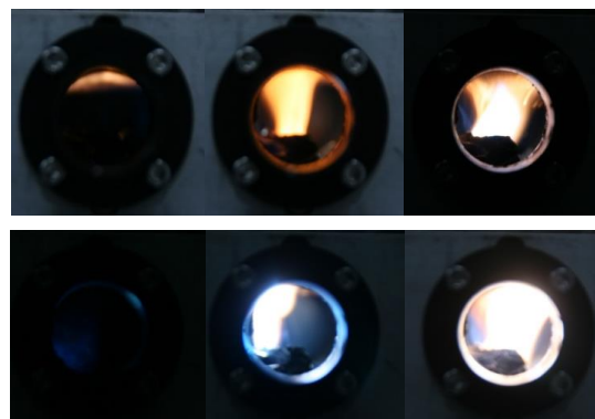
Fig.11 マイクロ波放電時の火炎画像
