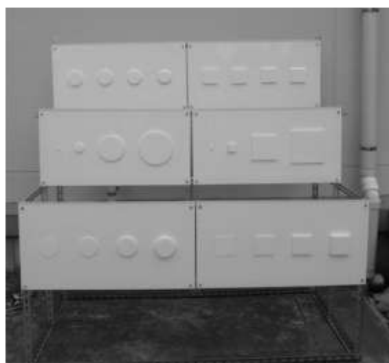
写真1 屋外暴露試験台
