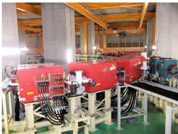
図 7 稀少 RI リング：赤が偏向電磁石、青が入射系 4 極電磁石、奥にクレーン用ホイストモーターが見える。
