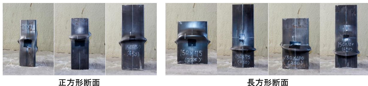
写真-1 CFT の最終破壊(座屈)形状
