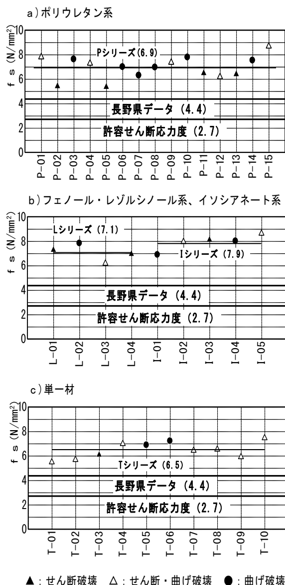
図-7 せん断強度と破壊形状
