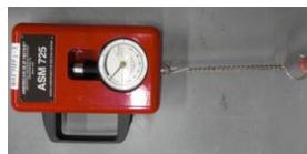
写真1 ASM試験機
