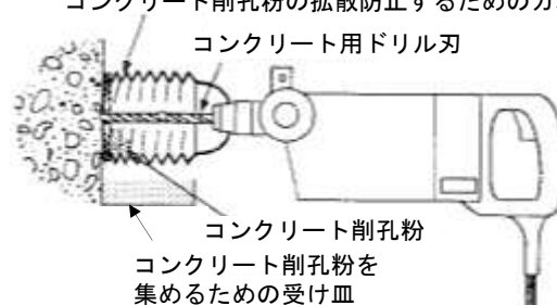
図-2 ドリル削孔粉の試料採取方法
