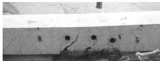
写真-5 コア抜き後の梁試験体
