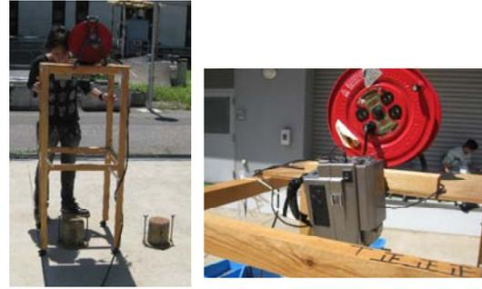
写真-1 赤外線カメラによる測定状況
