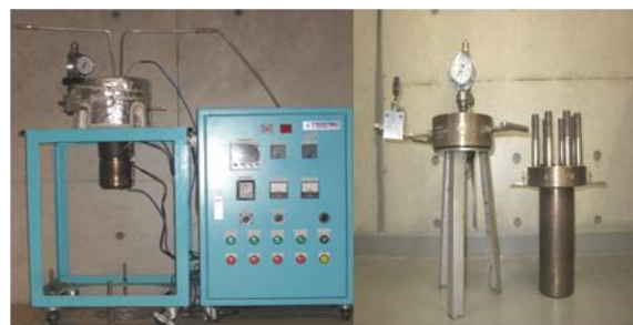
図-1 亜臨界水抽出試験装置
