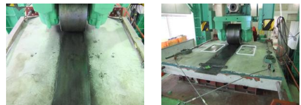
図.5 孔明および水張り状況
