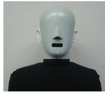
図 3 両耳聴ヘッドトルソの外観 (4100-D, Brüel&Kjaer)
