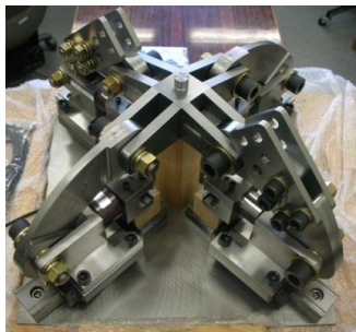
Fig.1 Biaxial tensile testing apparatus
