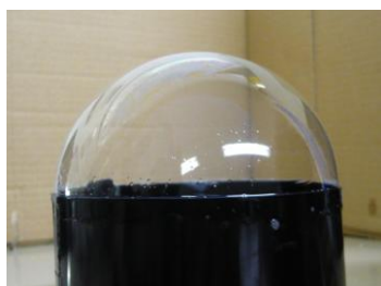
Photo.1 石鹼膜による空気膜の模擬
