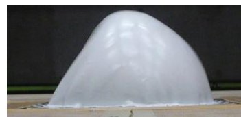
Photo.12 f=10\text{cm} 風向 90^\circ 変形写真
