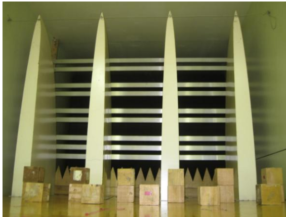
Photo. 2 乱流格子、渦発生装置及びバリアー設置状況
