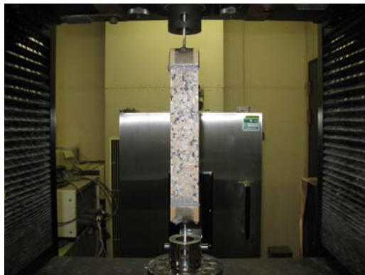
写真4 引張試験実施状況 (降雨による影響)
