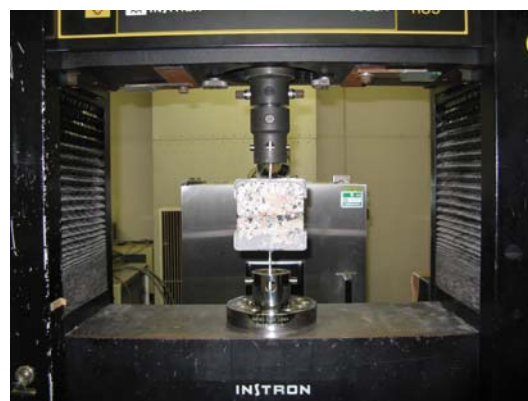
写真6 引張試験状況 (成形補修材)
