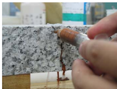
写真2 汚れの注入状況
