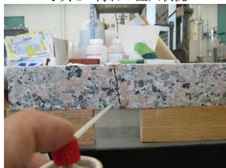
写真3 エアブローによる清掃状況
