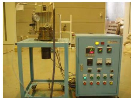
図 - 1 密閉反応試験装置
