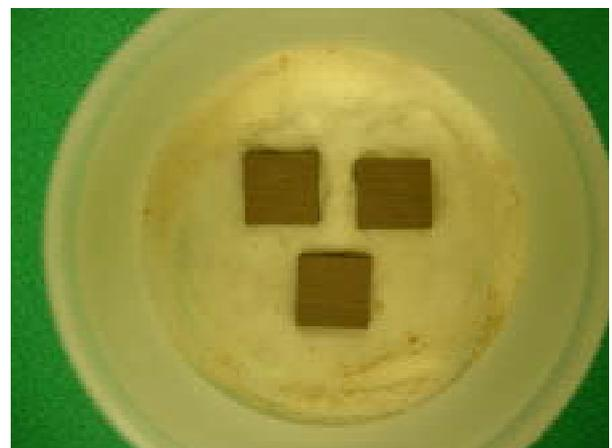
写真2 耐腐朽性試験；培養状況
