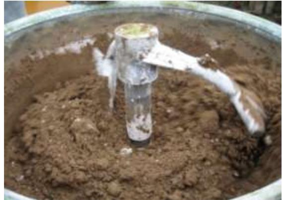
写真1 土と消石灰の攪拌状況
