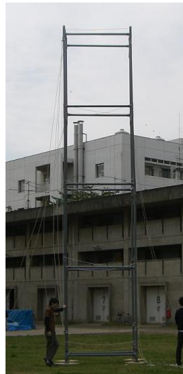
図 1 72[MHz]アンテナパターン測定装置
