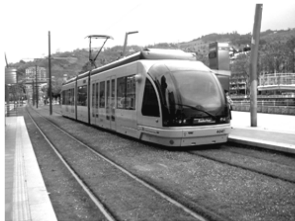
図6：トラムの路面に芝生が張り巡らされている。
