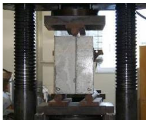
写真 2 試験体割裂状況
