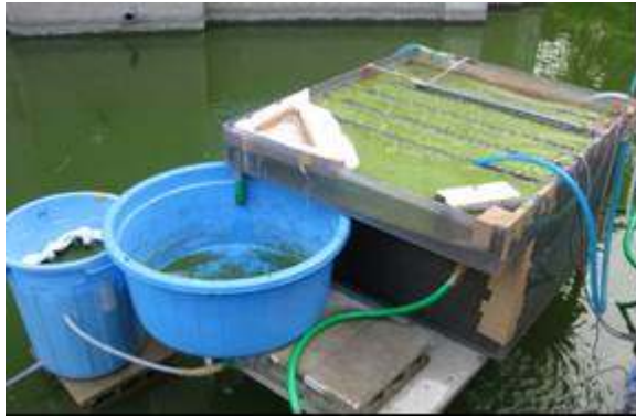
写真1 電解槽及びろ過槽
