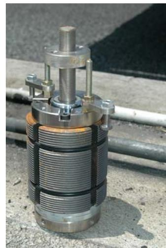
Fig. 8 支柱引抜きチャック装置
