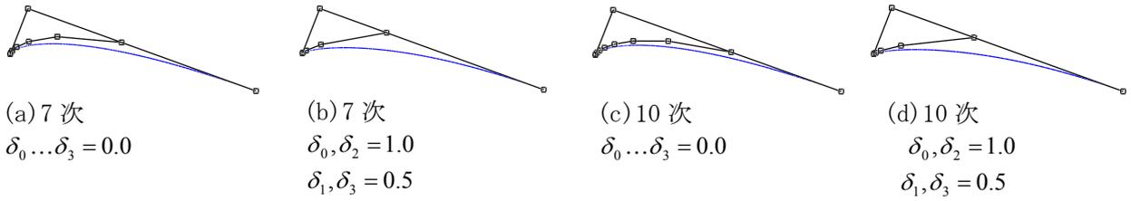
図6 高次の一般的な平面 Class A Bezier 曲線
