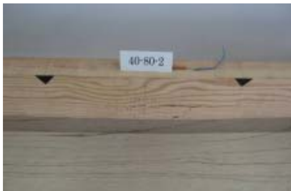
写真2 40-80-2試験体の破壊状況 (引張側の繊維の破断)
