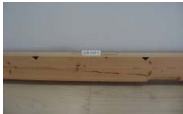
写真4 120-240-1 試験体の破壊状況 (はり成中央に、節がある場合も割れは節を貫通する)
