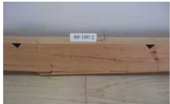
写真3 80-160-2試験体の破壊状況 (繊維破断は節位置から生じ、繊維方向に割れが生じた)
