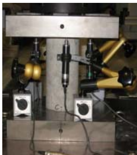
写真2 軸方向のひずみを求めるための変位測定
