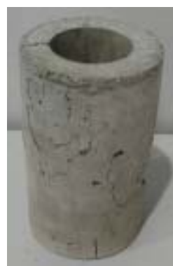
写真3 パイプ型の破壊状況
