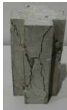
写真4 十字型の破壊状況
