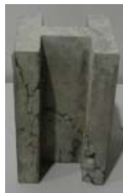
写真5 H型の破壊状況
