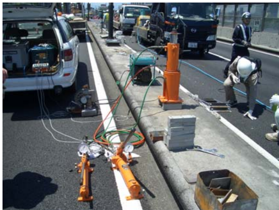
Fig. 8 首都高速3号線での引き抜き実験
