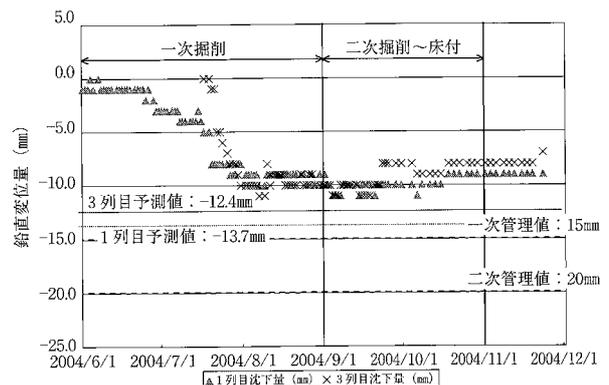
Fig.5 上部パイプルーフ鉛直変位計測結果
