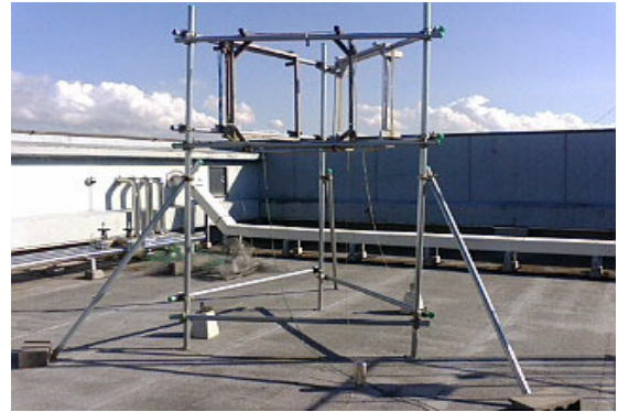
Fig. 2 指向性三方向ループコイルアンテナ このアンテナを用いて表1に示す日本各地及び周辺のさまざまな長波を観測している。 (2)
