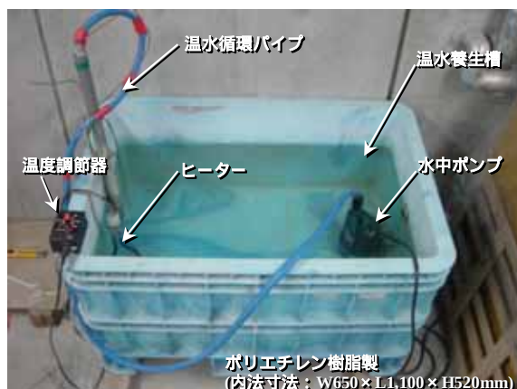
写真1 温水養生槽外観
