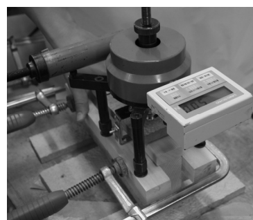
写真 2 簡易引張試験機によるくぎの引き抜き試験状況
