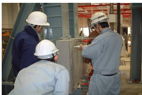
写真3 水平方向の反発度測定状況
