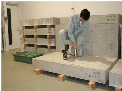
写真2 鉛直方向の反発度測定状況
