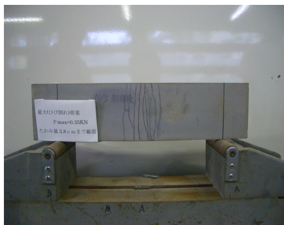
写真－2 ひび割れ状況
