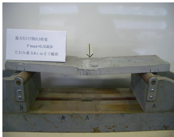
写真－1 曲げ試験状況
