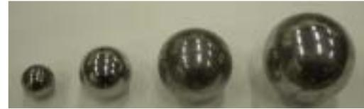
写真 4 はね返り試験に用いた鋼球
