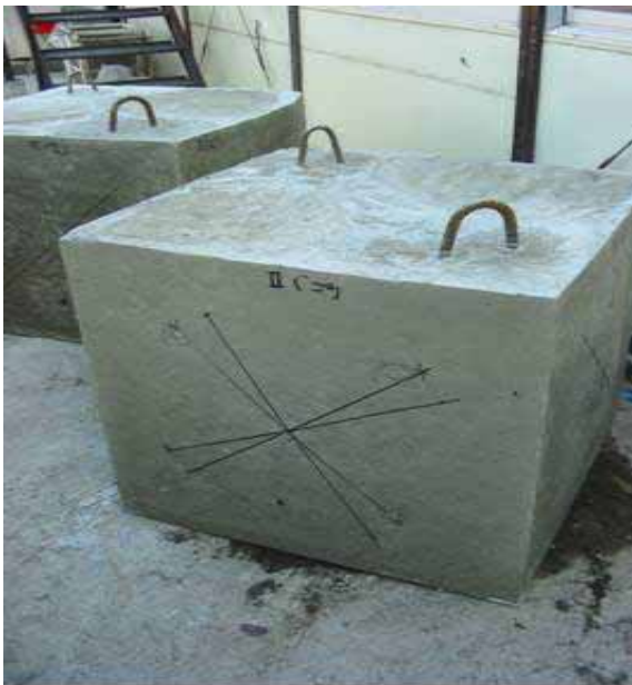
写真-5 コンクリートの表面状況 (廃木ボード 面)
