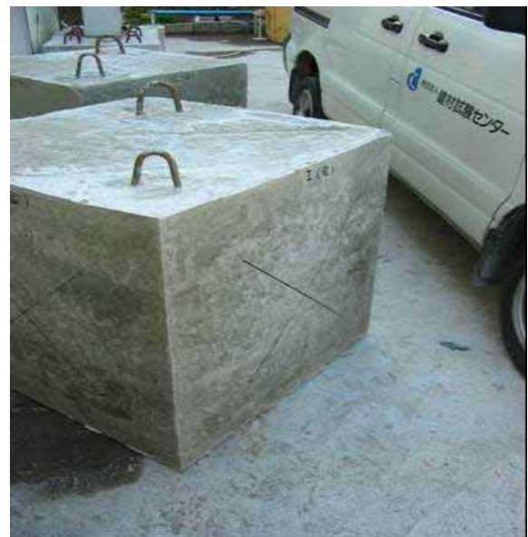
写真-7 コンクリートの表面状況 (合板 面)
